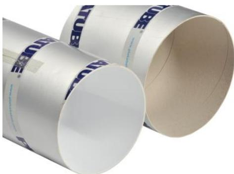
El PLAKATUBE es un encofrado tubular diseñado para columnas de diámetro de 15 a 120 cm, con una longitud estándar de 3 o 4 metros. Otras longitudes están disponibles bajo pedido.
