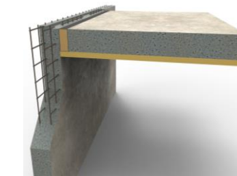
Bétonnage du plancher et de la rive
