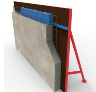
Bétonnage jusqu'en sous face de coffre
