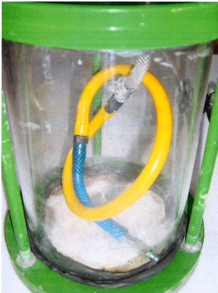
Figure 2: Installation d'essai pour l'examen du comportement sous l'action extérieure de la laitance sur le tuyau d'injection
