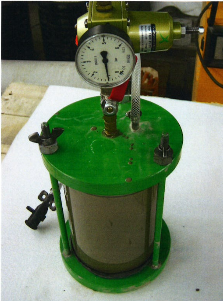
Figure 3: Tuyau d'injection sollicité à l'extérieur par de la laitance à une pression d'essai de 1 bar
