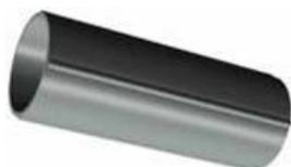
Capuchon en pvc, permettant de créer une chambre de dilatation à l'extrémité d'un goujon en acier de diamètre 25mm. La chambre de dilatation est assurée par deux fines lamelles croisées au fond du capuchon, qui permettent de maintenir un espace libre de 20mm lors de l'insertion du goujon sur chantier. Ces lamelles s'écraseront ultérieurement lors de la fermeture du joint de dilatation.
