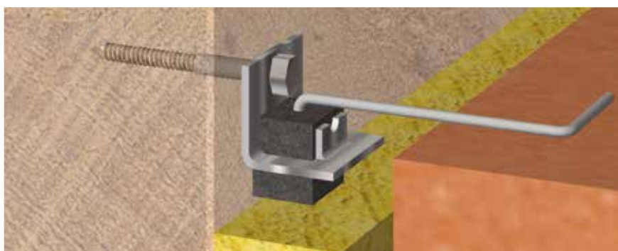
L'extrémité du crochet doit être visible sous le bloc acoustique
