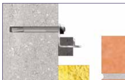
Fixation par boulon FSA M8
