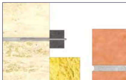
Introduire les extrémités du support en U dans les joints de maçonnerie
