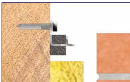
Fixation par vis à bois
